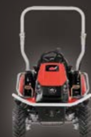
výška 1 740 mm s rámem, výška 1 370 mm se sklopeným rámem
