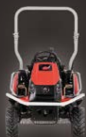
výška 1 740 mm s rámem, výška 1 370 mm se sklopeným rámem
